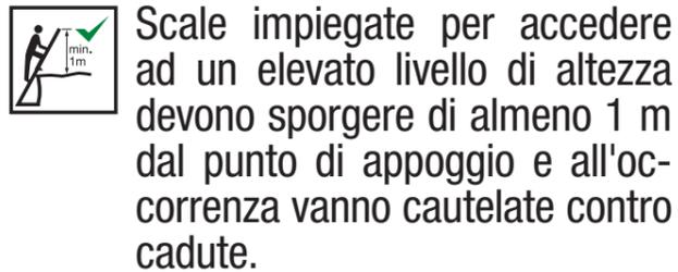
Scale impiegate per accedere ad un elevato livello di altezza devono sporgere di almeno 1 m dal punto di appoggio e all'occorrenza vanno cautelate contro cadute.
