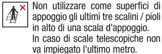
Non utilizzare come superfici di appoggio gli ultimi tre scalini / pioli in alto di una scala d'appoggio. In caso di scale telescopiche non va impiegato l'ultimo metro.
