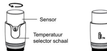
Draai de sensor ter controle van de temperatuur die op elke radiator is voorzien van een TRV. De instellingen zijn gemarkeerd met nummers in plaats van temperatuur.
