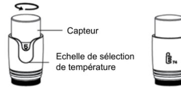
Tourner le capteur pour contrôler la température de chaque radiateur muni d'un TRV. Les paramètres sont marqués avec des chiffres plutôt qu'avec la température.
