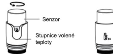
Otáčejte senzorem pro regulaci teploty na každém radiátoru vybaveném TRV. Číslo představují spíše nastavení než teplotu.
