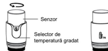
Rotiți senzorul pentru a controla temperatura fiecărui radiator echipat cu un TRV. Pozițiile sunt marcate cu numere și nu cu valoarea temperaturii.
