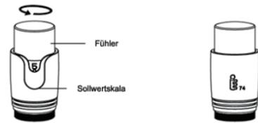
Drehen Sie den Sensor an jedem Heizkörper mit einem TRV, um die Temperatur zu steuern. Die Einstellungen werden mit Zahlenanstatt Temperaturangaben markiert.
