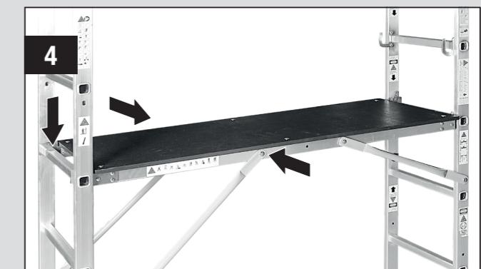
**Precauție!** Platforma de lucru se va folosi numai cu ambele traverse de la picior și toate cele patru bare de legătură montate. Dacă instalația nu poate fi efectuată cu succes, luați legătura cu HORNBACH. Nu folosiți produsul în astfel de situații.
