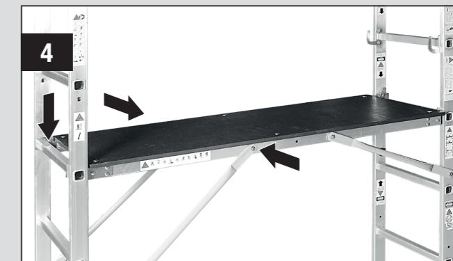
**Attenzione!** Utilizzare la piattaforma di lavoro solamente con entrambe le traverse di appoggio e tutti i quattro traversi montati. Se non è possibile completare l'installazione, contattare HORN BACH. In questo caso non utilizzare il prodotto.
