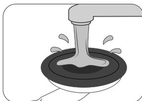
7. Eventuelní špínu a nebo jiné nečistoty na přísavce můžete vodou o mýdlem odstranit. (V žádném případě nepoužívejte přípravky na bázi rozpouštědel, kyselé nebo abrazivní prostředky) poté je držák opět připraven k použití. Řiďte se opět předchozími body 1-5
