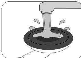
7. Posibile reziduuri de murdărie sau altele similare de pe ventuză pot fi îndepărtate cu apă și săpun standard comercial. Nu folosiți agenți de curățare pe bază de solvenți, acizi sau abrazivi! După o curățare corectă, mânerul de prindere este gata de utilizare din nou. Vă rugăm să respectați pașii 1. - 5.
