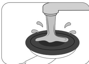
7. Los posibles residuos de suciedad o similares en la ventosa se pueden eliminar con agua y agua con jabón comercial estándar. ¡No utilice productos de limpieza a base de solventes, ácidos o abrasivos! Después de una limpieza adecuada, el asa está lista para usar nuevamente. Respete los pasos 1. - 5.
