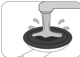
7. Eventuelle rester af snavs eller ligende på sugekoppen kan fjernes med vand og almindeligt sæbevand. Brug ikke opløsningsbaserede, syreholdige eller slibende rengøringsmidler! Efter ordentlig rengøring er gribehåndtaget klar til brug igen. Overhold venligst trin 1. - 5.
