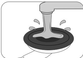
7. Ewentualne zabrudzenia lub podobne zanieczyszczenia z przyssawki można usunąć za pomocą wody i standardowej wody z mydłem. Nie należy używać środków czyszczących na bazie rozpuszczalników, kwaśnych lub ściernych! Po prawidłowym wyczyszczeniu uchwyt jest ponownie gotowy do użycia. Przestrzegaj kroków 1. - 5.
