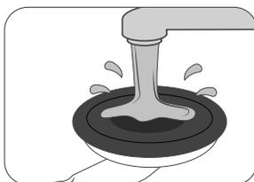
7. Eventualne ostatke prljavštine ili sličnog na usisnoj čašici mogu se ukloniti vodom i uobičajenom komercijalnom vodom sa sapunom. Ne koristite sredstva za čišćenje na bazi otapala, kisela ili abrazivna! Nakon pravilnog čišćenja, hvataljka je ponovno spremna za upotrebu. Molimo poštujte korake 1. - 5.
