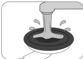
7. Possíveis resíduos de sujidade ou similares na ventosa podem ser removidos com água e sabão. Não use produtos de limpeza abrasivos ou à base de solvente! Após a limpeza adequada, a barra de apoio está pronta para uso novamente. Por favor, respeite as etapas 1. a 5.
