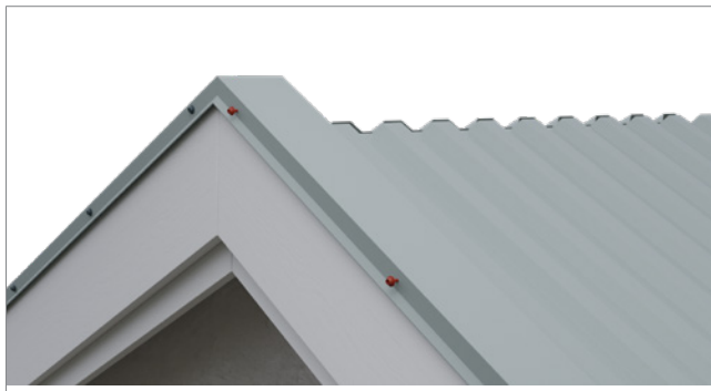
Använd Lindab vindskivebeslag för att täcka takets gavlar. Infästning cc 400 mm.
