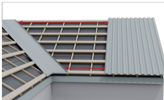
Mät två avstånd för att hitta rätt vinkel. Plåten bör gå ca 30 mm ut i rännalen.
