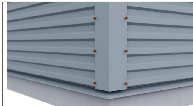
Använd Lindabs hörnbeslag HBY i ytterhörn och HBI i innerhörn. Fäst med självborrande skruv eller trycktät blindnit.
