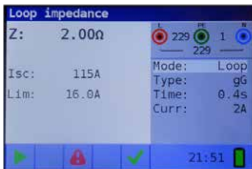
Figur 4 23: Exempel på resultat av kretsimpedansmätning
