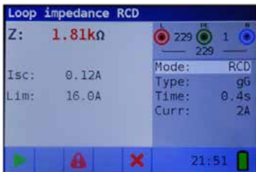
Figur 4 25: Exempel på resultat av felkretsimpedansmätning med trip-lock funktion
