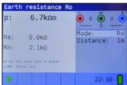
Figur 4 41: Exempel på resultat av mätning av specifik jordresistans
