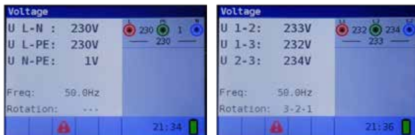
Figur 4 34: Exempel på spännings- och frekvensmätningar
