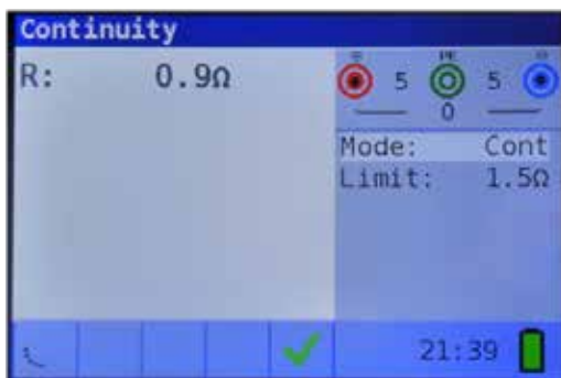
Figur 4 10: Exempel på resultat av lågströmskontinuitetsmätning
