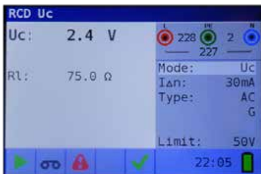
Figur 4 13: Exempel på resultat av kontaktspänningsmätning
