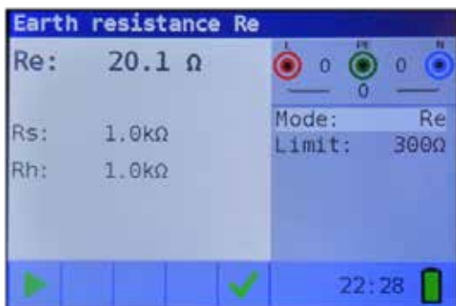
Figur 4 38: Exempel på resultat av mätning av jordresistans
