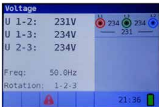
Figur 4 31: Exempel på resultat av fasföljdtest
