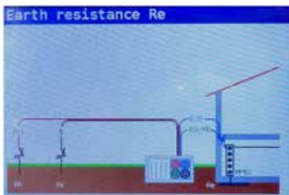
Figur 4 37: Kopplingsschema för 3 ledare
