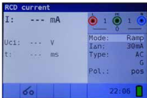
Figur 4 16: Meny för mätning av utlösningssström
