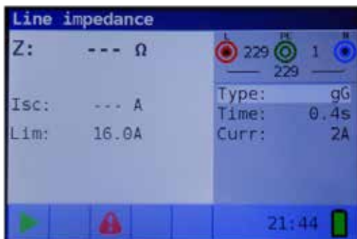
Figur 4 26: Meny för mätning av ledningsimpedans
