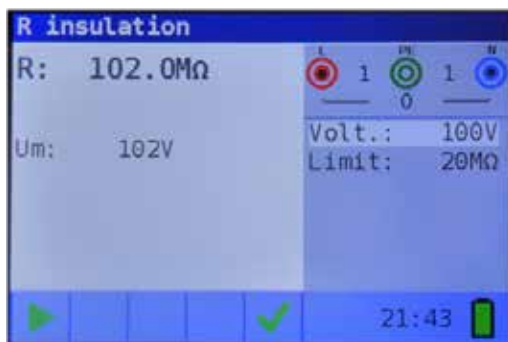
Figur 4 3: Exempel på resultat av mätning av isolationsmotstånd
