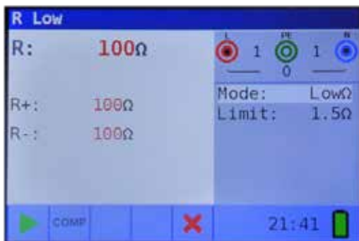
Figur 4 7: Exempel på resultat av låg resistansmätning
