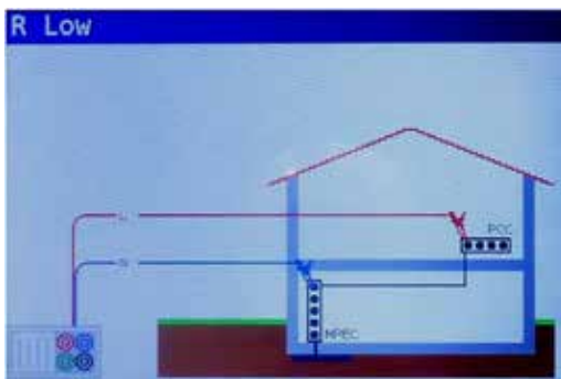
Figur 4 6: Anslutning av universell testkabel
