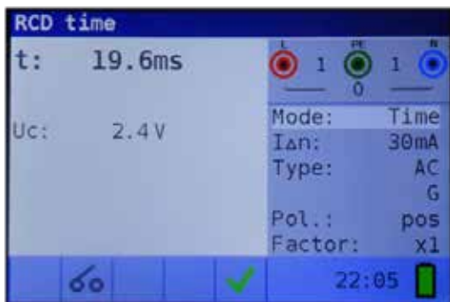
Figur 4-15: Exempel på resultat av utlösningstidsmätning
