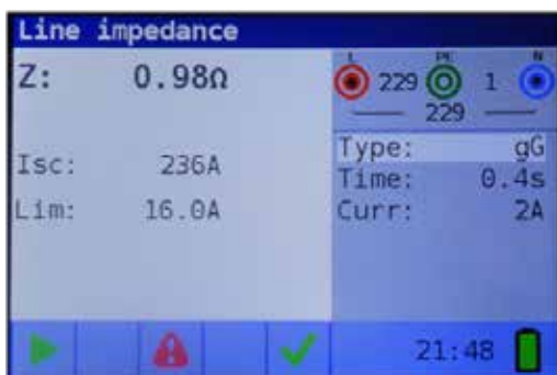
Figur 4 28: Exempel på resultat av mätning av ledningsimpedans
