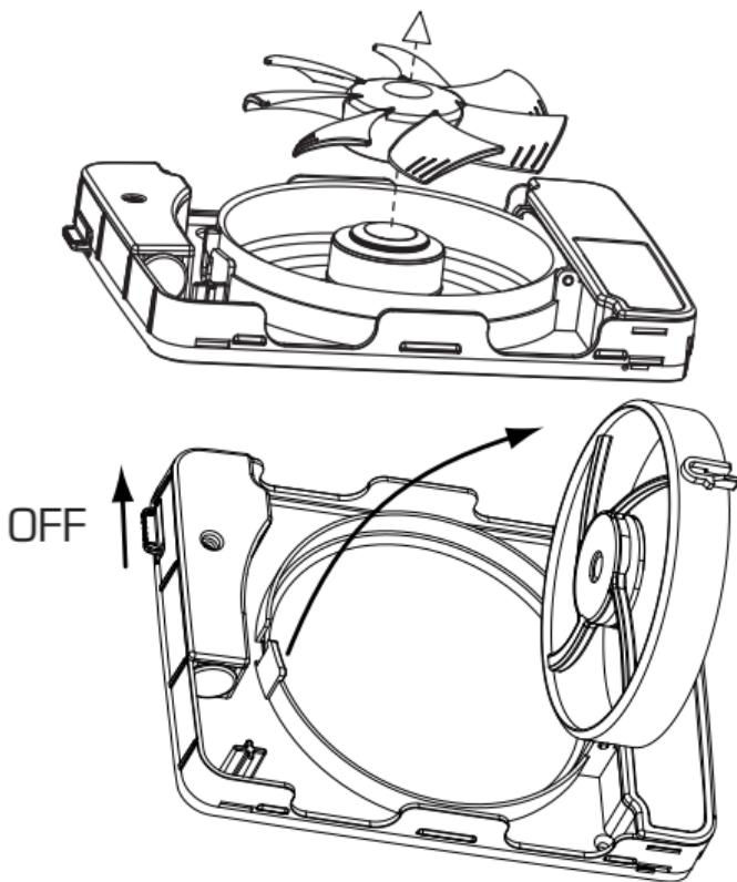
Det er viktig å rengjør propellens vinger om det er et skittent belegg på dem. Om det ikke gjøres er det mulighet for ubalanse som forårsaker økt støynivå og reduserer motorens levetid.
