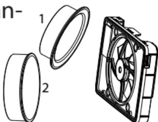
Vid montering, se till att tätning finns mellan rör/ kanal och vägg/tak för att förhindra att fuktig luft / kondens tar sig in i väggen eller innertaket.
