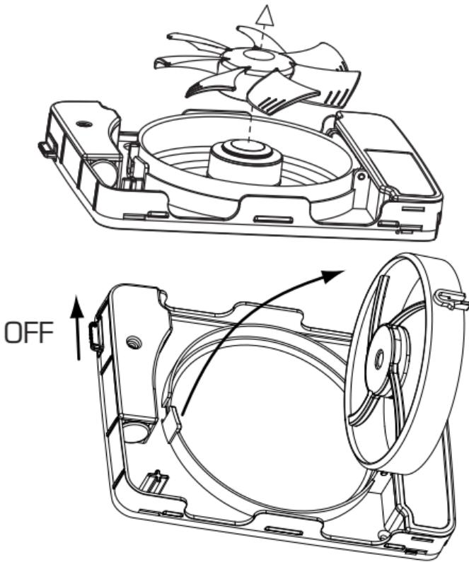
Rengør kanalen, hvis denne er beskidt(et beskidt rør, nedsætter ydeevnen). Rengør også propellens vinger, for at undgå ubalance og nedsat ydeevne - som giver øget støj og reducerer levetiden på de motoriske lejer.
