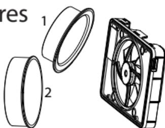
Ved montering må det påses at det er tetning mellom rør/kanal og vegg/tak for å hindre at fuktig luft/kondens trenger inn i vegg eller himling. Bruk de medfølgende skruer og plugger om nødvendig.
