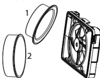
Ved montering skal der etableres tætning mellem rør/kanal og væg/loft for at forhindre, at fugtig luft/kondens trænger ind i væggen eller loftet.
