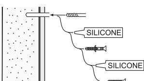
Skruvinfästningar i våtzon 1 ska göras i betong eller annan massiv konstruktion, träreglar, träkortlingar eller i konstruktion som är provad och godkänd för infästning, till exempel skivkonstruktion. Se exempel på godkända konstruktioner på säkervatten.se.
