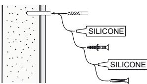
Skruvinfästningar i våtzon 1 ska göras i betong eller annan massiv konstruktion, träreglar, tråkortlingar eller i konstruktion som är provad och godkänd för infästning, till exempel skivkonstruktion. Se exempel på godkända konstruktioner på säkervatten.se.
