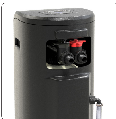
Bild 2. Filtrets spolvatten anslutning fungerar även som överfyllnadsskydd, anslutning sker med 1/2" slang, använd slangklamma. Om längre slang än 2 meter krävs, övergå till 40 mm plaströr.
