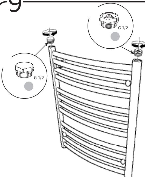
SE Pluggarna och luftningen är o-ringstätade och ingen övrig gängtätning behövs. Pluggarna och luftningen dras till de bottnar helt mot handdukstorken. Kontrollera att anslutningarna är tätta efter installation
