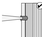
Fyll hela hålet med åldersbeständig tätningsmassa.
