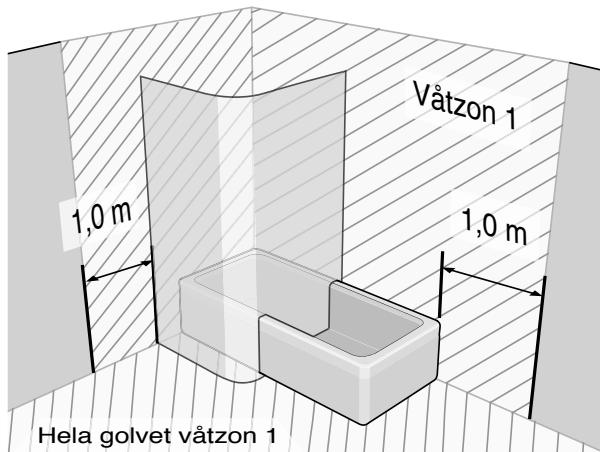
Skruvinfästningar i våtzon 1 ska göras i massiv konstruktion såsom betong, reglar, särskild konstruktionsdetalj eller Våtrumsvägg 2012. Skruvinfästningar i våtzon 1 får ej göras enbart i golv- eller väggskiva
