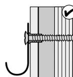
Använd VVS-skruv. Skruva genom plywoodskivan.
