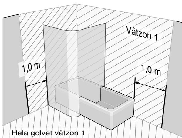
Skruvfästningar i våtzone 1 ska göras i massiv konstruktion såsom betong, regler, särskild konstruktionsdetalj eller Våtrumsvägg 2012. Skruvfästningar i våtzone 1 får ej göras enbart i golv- eller väggskiva (SäVa § 2.11.1 & Våtrumsvägg 2012)
