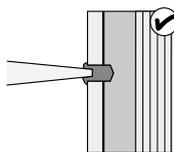
Fyll hela hålet med åldersbeständig tätningsmassa.
