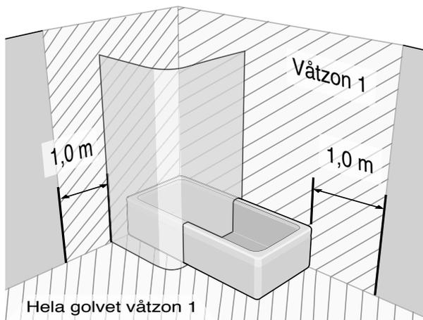
Skruvfästningar i våtzon 1 ska göras i massiv konstruktion såsom betong, reglar, särskild konstruktionsdetalj eller Våtrumsvägg 2012. Skruvfästningar i våtzon 1 får ej göras enbart i golv- eller väggskiva (SäVa § 2.11.1 & Våtrumsvägg 2012)
