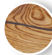
Topp- och ytsprickor
