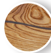
Topp- och ytsprickor
