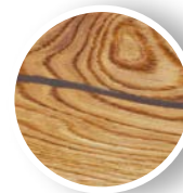
Topp- och ytsprickor
