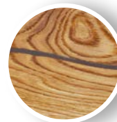
Topp- och ytsprickor
