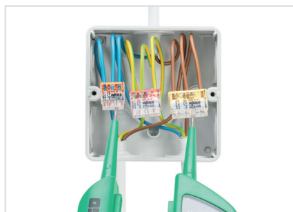
Testa via testöppning på motsatt sida om klämmans ingång.
